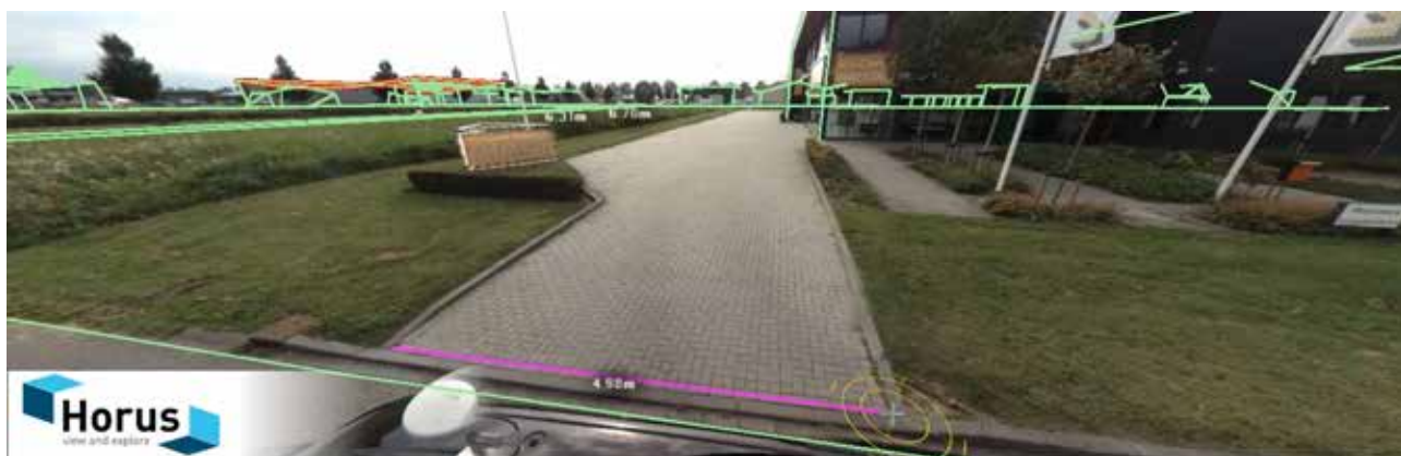
Datele vectoriale 3D se pot suprapune peste fotografii. Se pot măsura și digitiza elemente noi din imagini.
