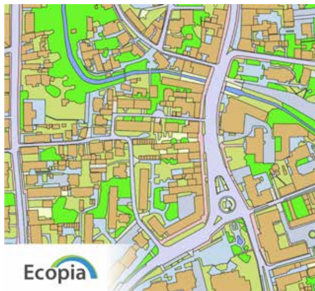
Ortofotoplan și date topografice extrase automat din acesta cu ajutorul inteligenței artificiale.
