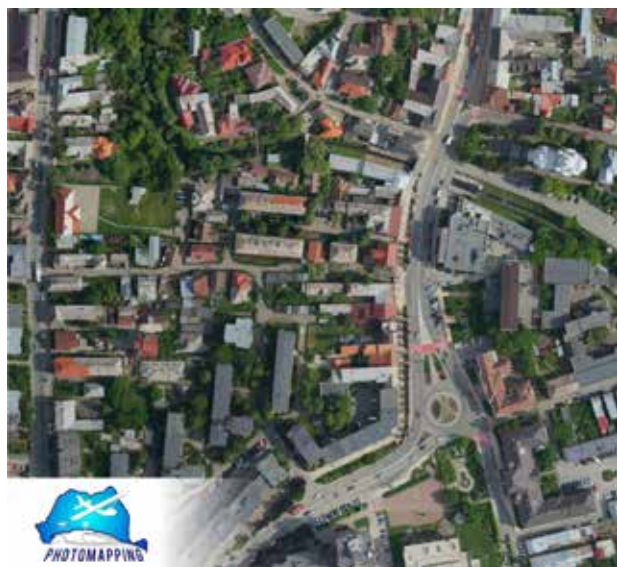
Ortofotoplan și date topografice extrase automat din acesta cu ajutorul inteligenței artificiale.
